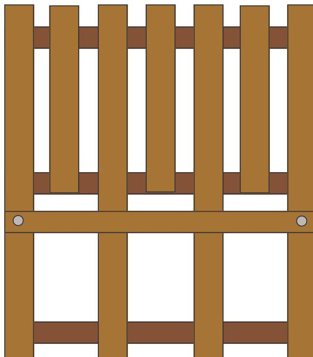
ajouter une planche horizontale fixée avec des boulons poiliers pour régler la hauteur de passage et éviter l'entrée des brebis.
